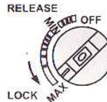
Tournez le bouton de réglage jusqu'à la position « MAX » afin de réaliser l'allumage et repositionner l'anneau.
