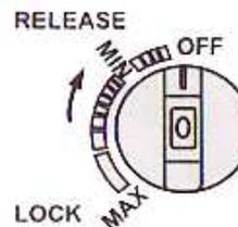
Positionner le bouton de réglage sur la position « OFF » afin d'assurer la coupure d'alimentation du gaz.
