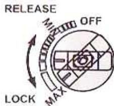
Tournez le bouton de réglage de la position « MIN » à la position « MAX » afin de régler la flamme à l'intensité désirée.
