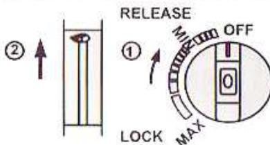
Tourner le bouton de réglage sur la position « OFF » et relevez le bouton d'enclenchement de gaz sur la position « RELEASE » afin d'enlever la cartouche de gaz.
