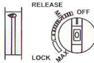
Assurez-vous de bien positionner le bouton de réglage sur la position « OFF » et le bouton d'enclenchement de gaz sur la position « RELEASE ».
