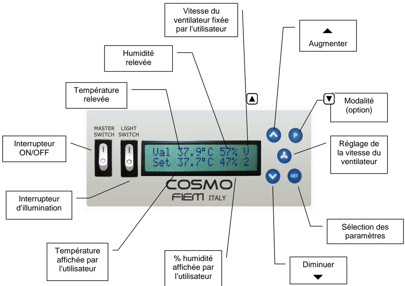
En cas d'erreur dans lecture de la sonde ou du capteur d'humidité, au lieu des valeurs relevées l'écran montrera des astérisques (\*\*).
