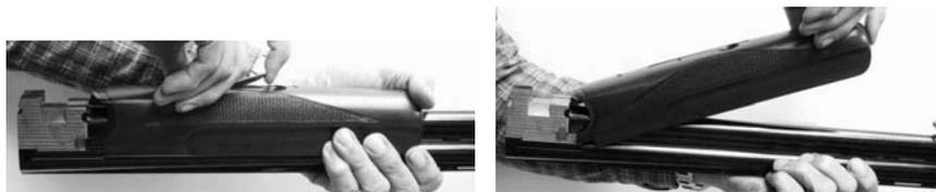
2. Poussez la clé se trouvant sur la bascule vers la droite et introduire le canon à l'intérieur de la bascule.
