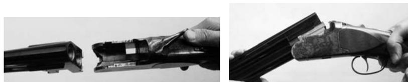
3. En poussant le canon, fermez le fusil. Montez le devant sous le canon jusqu'à ce que l'on entende le déclic provoqué par le crocheteage.
