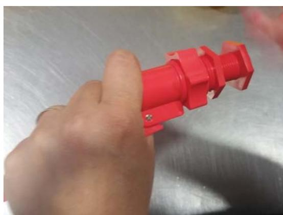
Dévissez et remuez l'écrou en plastique plus à l'extérieur du bras du flotteur.
